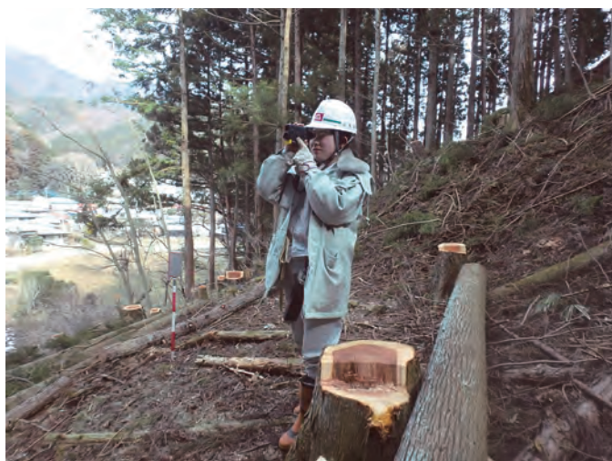
デジタルコンパスで測量している様子
